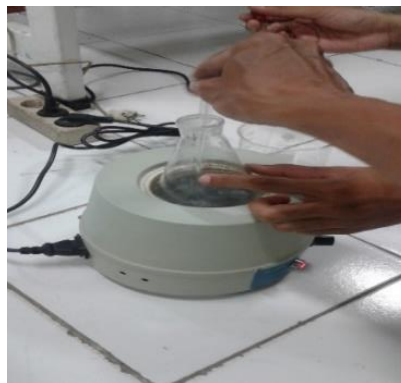
Gambar 4.6 Proses Pengkristalan
